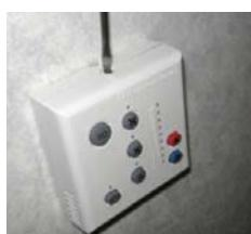
Заново соедините заднюю и переднюю части корпуса блока управления. Конец кабеля управления со стороны воздушной завесы должен быть вставлен в одно гнездо RJ, установленное или на верхней панели для NT или на материнской плате Ecopower внутри утопленной воздушной завесы. Обеспечить надежный крепеж кабеля управления.
