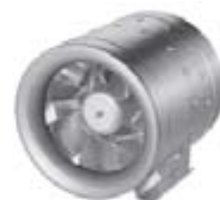
630 мм EUR 710 мм EUR EL 630 EC 01 ID 119322 2335,- EL 710 EC 01 ID 119359 2800,- 400V 3~/50Hz 50 °C 15100 m³/h 2.250 W 3,8 A 88/90/81 db(A) 400V 3~/50Hz 80 °C 20200 m³/h 3.100 W 5,7 A 88/92/80 db(A) Вентиляторы ETALINE с электродвигателями ЕС должны быть подключены к контроллерам (см. дополнительные принадлежности).
