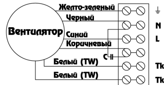
Схема № 6 ~ 220В, 1 фаза, вынесенный термоконт
