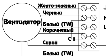
Схема № 5 ~ 220В, 1 фаза, внутренний термоконт
