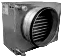
ВОДЯНОЙ НАГРЕВАТЕЛЬ Heru 130 S and 180 S. 5 kW вкл. 2- или 3-ходовой клапан и двигатель клапана, а также датчик против обморожения.
